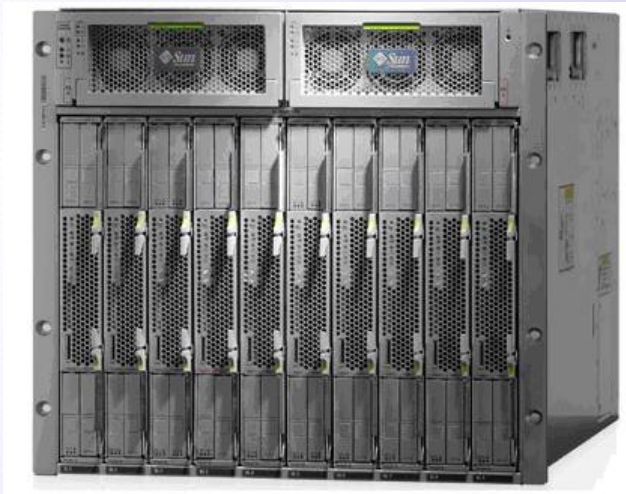
Рисунок 2.2: Типичное 10U шасси для 10 Blade-серверов (Sun Blade 6000) используемое в БрГУ
