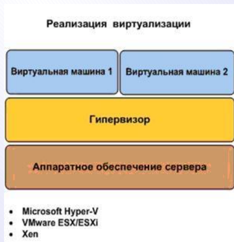
Рисунок 3.12: Архитектура виртуализации с гипервизором
