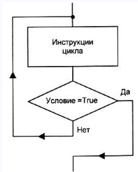
Рис. 2.27: Блок-схема оператора цикла Repeat...until
