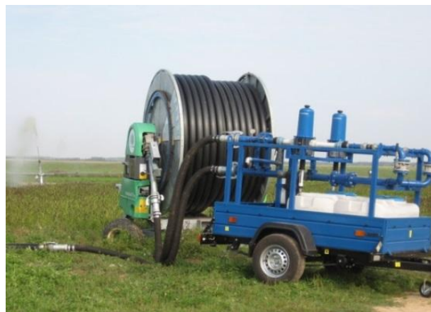
Рис. 2. Оборудование для гидроподкормки ОГД-50 к дождевальной установке Rainstar T 61 при проведении испытаний
