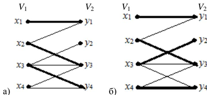
Рисунок 3. – а) паросочетание, б) максимальное паросочетание
