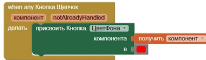
Рисунок 3 – Использование механизма «Любые компонентные блоки» для тех кнопок на сцене, для которых наступило событие Щелчок
