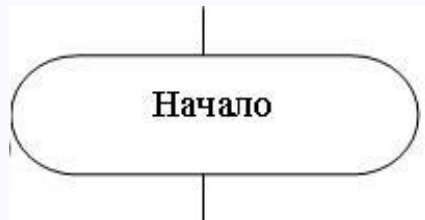
Рис. 1.1: Блок начала, конца алгоритма, вход и выход в подпрограмму
