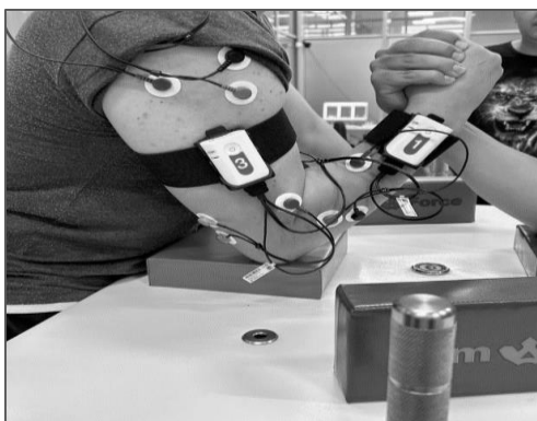
Рисунок 3 – измерение напряжения мышц с помощью электромиографических датчиков
