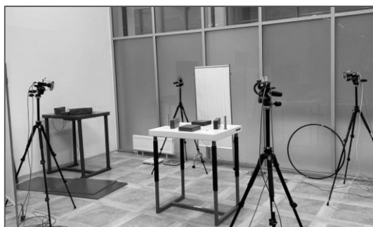
Рисунок 2 – расстановка камер для съятия показаний со светоотражающих маркеров
