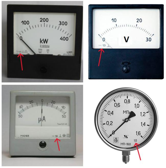
Рисунок 3 – Пример отображения класса точности
