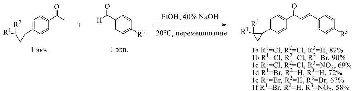
Рисунок 1 – Схема синтеза соединений 1a–f и их выход
