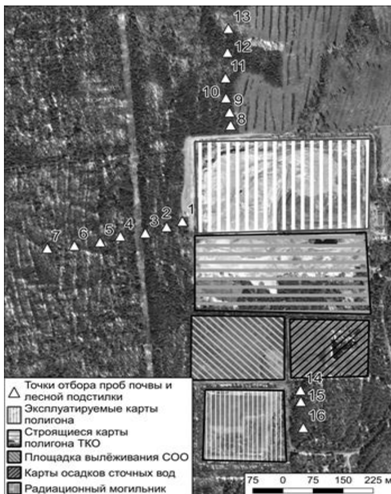
Рисунок 1 – Схема расположения пробных площадок в зоне влияния полигона ТКО г. Бреста (окрестности д. Струга)
