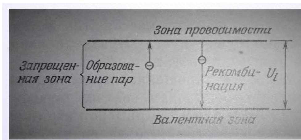
Рисунок 7.2 – Образование пар носителей заряда и рекомбинация в зонной модели
