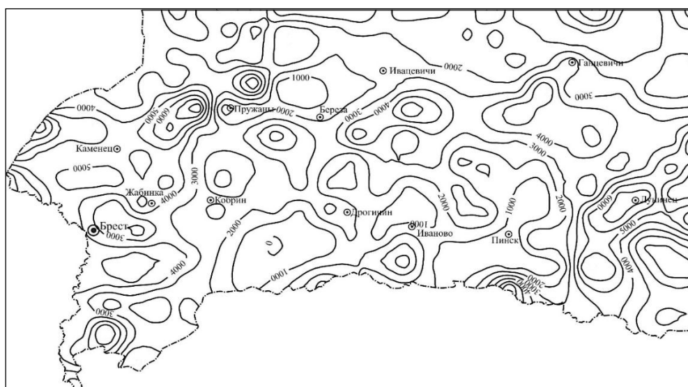
Рисунок 2. – Объемы перемещенных грунтов по территории юго-запада Беларуси в результате строительства автомобильных дорог, \text{м}^3/\text{км}^2
