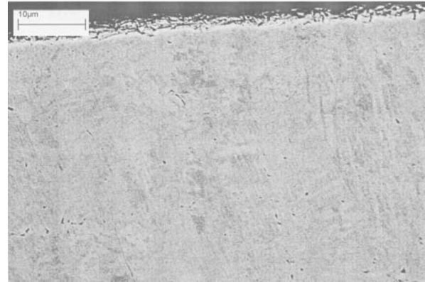
Рисунок 3 – Поперечное сечение фольг сплава Bi – 0.5 ат. % Cu
