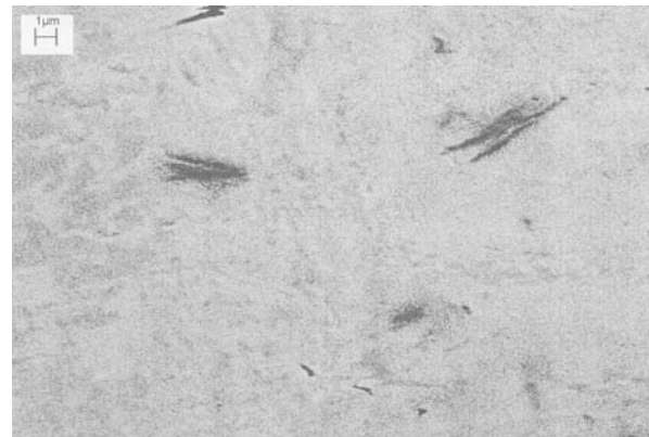
Рисунок 3 – Поперечное сечение фольг сплава Bi – 0.5 ат. % Cu
