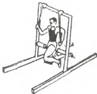
Рисунок 13 – Техническое устройство для формирования бегового шага в высокой опоре (рывково-тормозного характера) с разнонаправленной тягой резины или регулируемым отягощением
