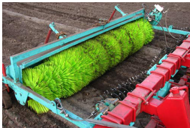
Рис. 1. Агрегат универсальный для возделывания бахчевых культур со щеточным барабаном
