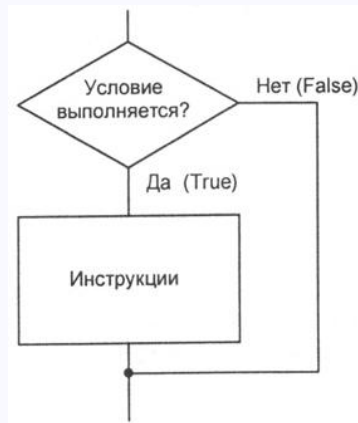
Рис. 2.2: Сокращённая форма записи логического оператора If-then
