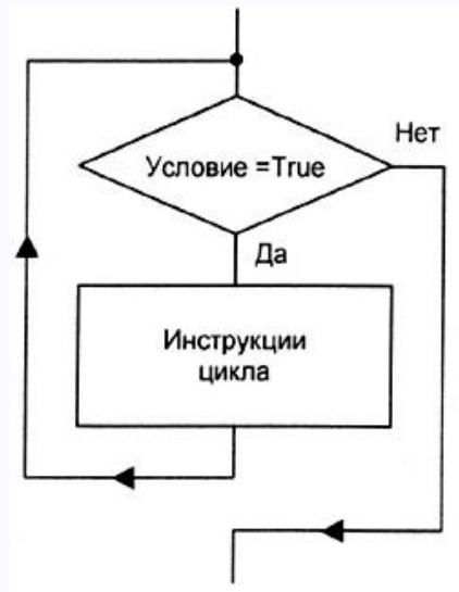
Рис. 2.7: Блок-схема оператора While
