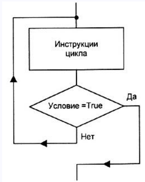
Рис. 2.9: Блок-схема оператора цикла Repeat...until
