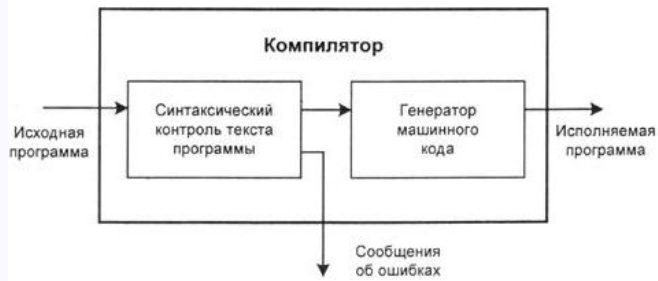
Рис. 1.14: Схема работы компилятора
