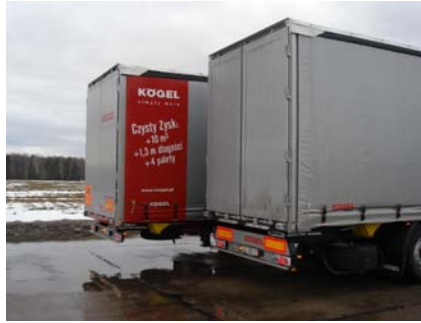
Рисунок 13 – Стандартный и удлинённый на 1,3 м трейлеры
