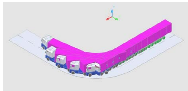
Рисунок 3 – Траектории движения транспортного средства с трейлером при движении на закруглении дороги (вид слева)
