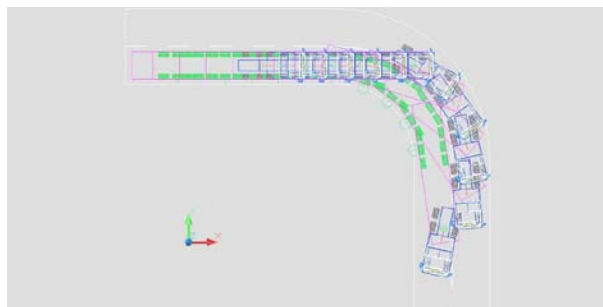
Рисунок 4 – Траектории движения транспортного средства с трейлером при движении на закруглении дороги (вид сверху)
