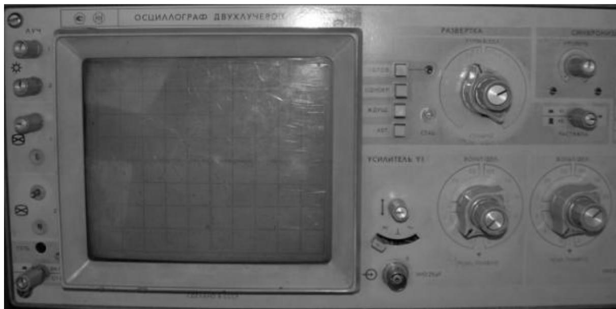
**Включите вилку питания осциллографа в сеть. Нажмите кнопку включения осциллографа, которая находится в левом нижнем углу лицевой панели. Через некоторое время, необходимое для разогрева катода ЭЛТ, на экране появятся две светящиеся горизонтальные линии развертки.**
